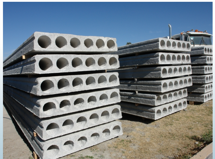
Almacenaje de piezas en planta
